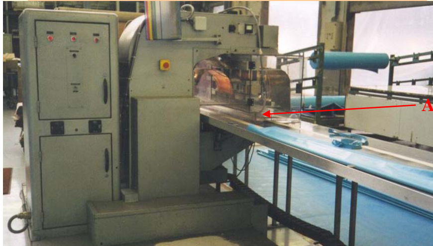
Exemple 3 : Soudage de bâche, semi-automatisé
