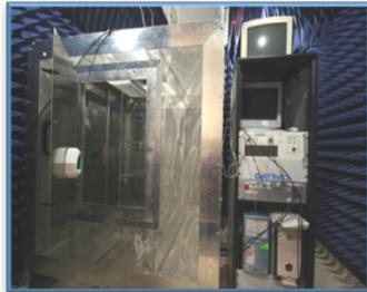
Une chambre réverbérante a été spécialement conçue pour ce projet avec SATIMO permettant l'exposition des animaux « corps-entier » à 2450 MHz sans contrainte de mouvement.
